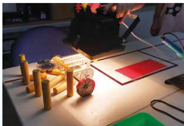
圖 6 進行太陽能車馬力測試
