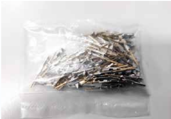
杜邦端子 - 製作水泵的杜邦線用
