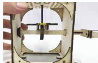
圖 4 凸輪機構作動單元部件
