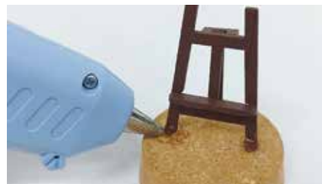
圖 11. 使用熱熔膠槍固定素材省時又快速
