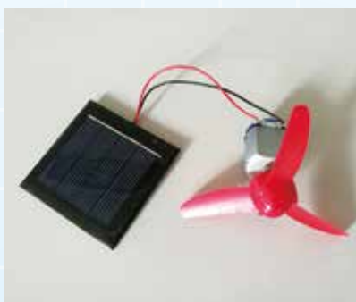
圖 8 太陽能發電提供風扇動力
