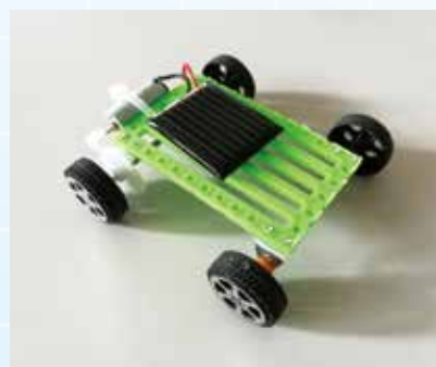
圖 9 太陽能發電提供車子動力
