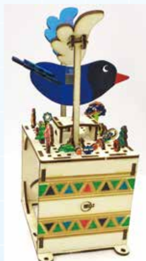
圖 5 臺灣藍鵲翅膀與凸輪機構連接連動
