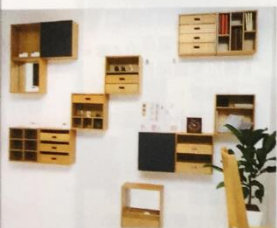
■ 圖2-13 壁掛式的櫥櫃設計，可避免地震時物體震落。
